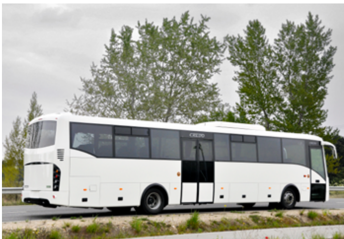
Az 1-2-0 ajtóképletű változat (Credo Inovell 12 EC) a széles középső ajtóval még gyorsabb utasáramlást tesz lehetővé.
