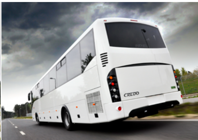
A hátsó lámpafészkeket összekötő ív, amely légbeömlőként is funkcionál - egy- sleges megjelenést biztosít minden Credónak várositól a távolsági kivitelig.
