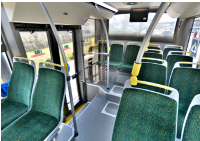
A lépcsők alacsony szintje megkönnyíti a hátsó szakaszba való eljutást, a szinte teljesen sík padló pedig itt is kényelmessé teszi az állva utazást.
