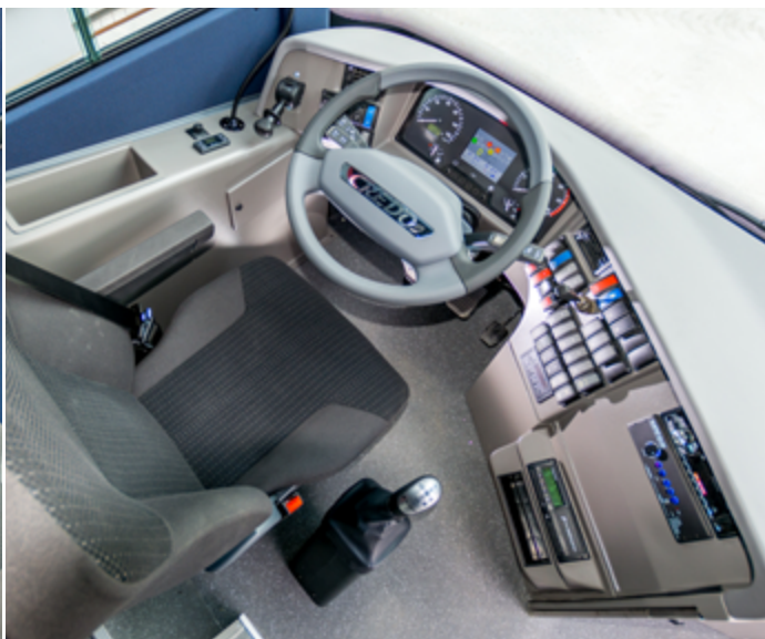
Az Optinell az opcionális vezetői asszisztens szolgáltatások megrendelése esetén speciális, rezgőmotoros vezetőüléssel készül.
