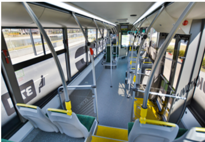
Hosszú peronrész az egyik oldalon, két sor ülés a másikon: magas befogadóképesség csúcsidőben, maximális kényelem a kevésbé zsúfolt időszakokban.
