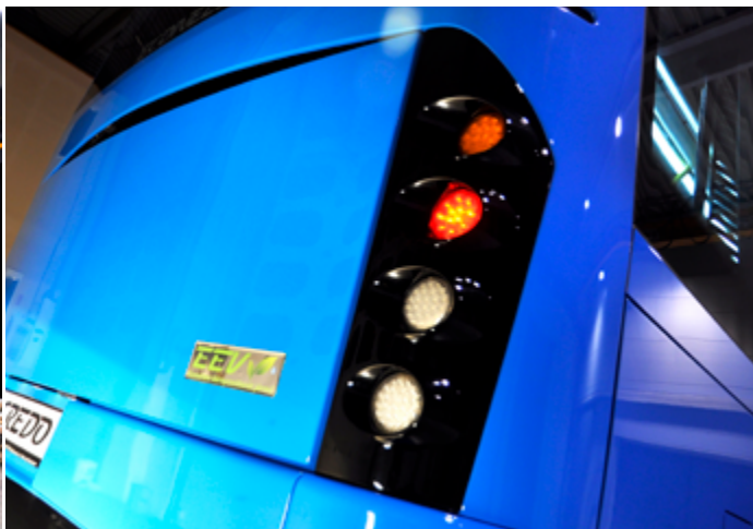
A hátsó lámpafészek kontúrjait a motortérajtó fölötti ív köti össze, amelyet a lökhárító fényezése is követ. A fekete betétek színe szabadon választható.
