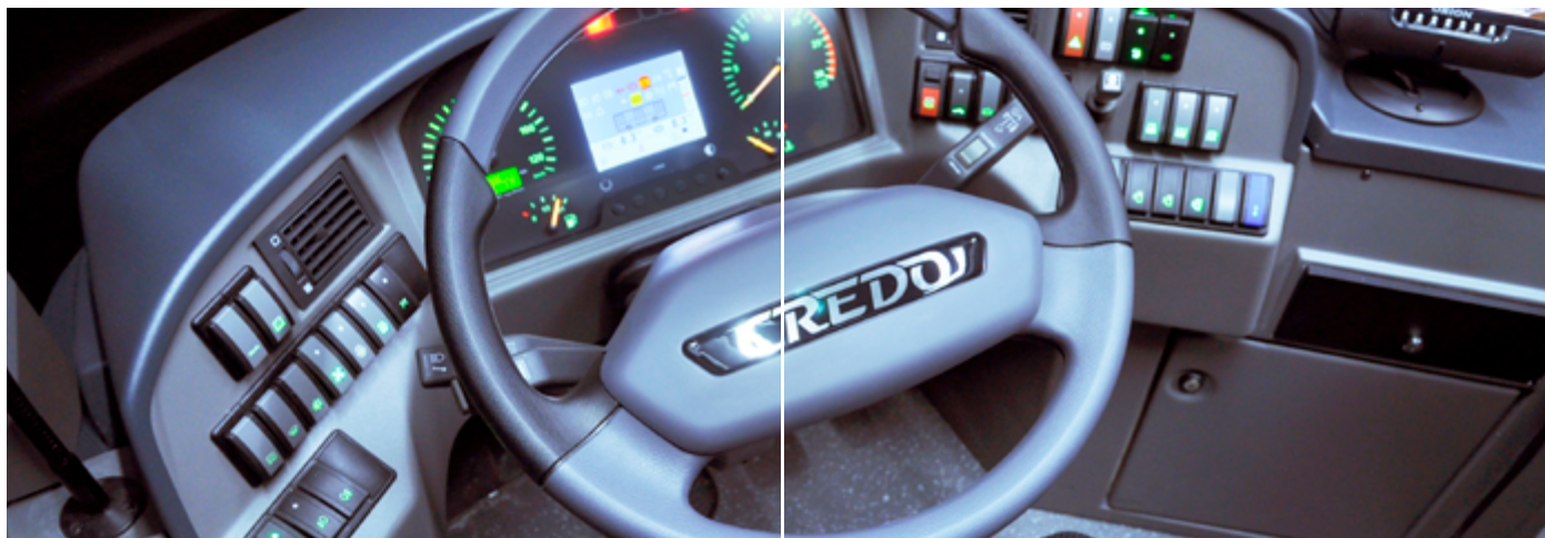
A kormány magassága és dőlésszöge - a vezetőüléssel és az elektromos tükrökkel együtt - tág határok között állítható.
